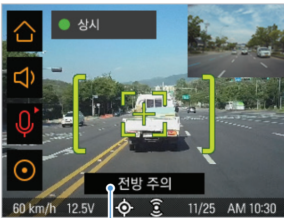
1차 전방 충돌 경보: 초기 전방 충돌 위험을 감지할 때 표시됩니다.
