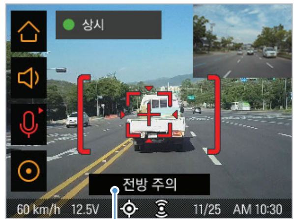
2차 전방 충돌 경보: 초기 전방 충돌 감지 위험을 감지한 후 앞차와의 간격이 더욱 줄어들 때 표시됩니다.
