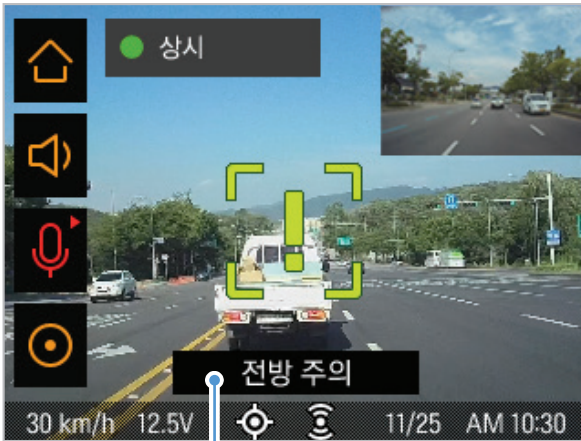
1차 저속 전방 추돌 경고: 초기 저속 전방 추돌 위험을 감지할 때 표시됩니다.
